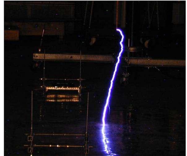
(d) Flash to the ground, positive polarity.
