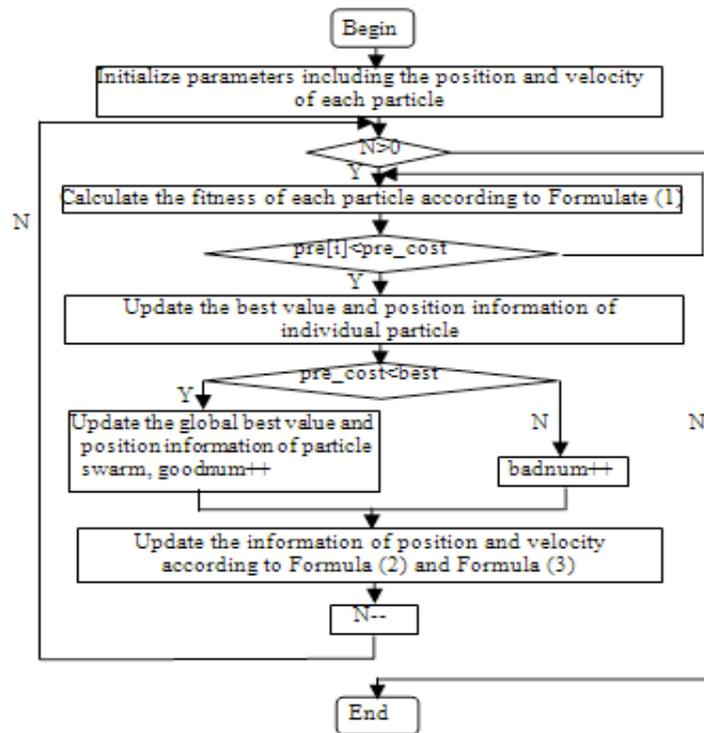
Fig. (1). Flowchart of PSO-NoC algorithm.
