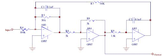
Fig. (7). Filter circuit.
