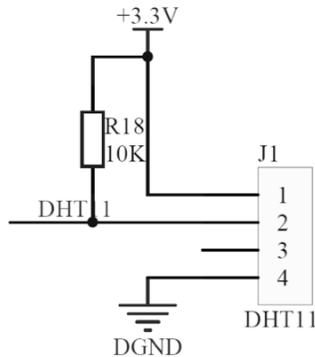
Fig. (4). DHT11 hardware circuit diagram.
