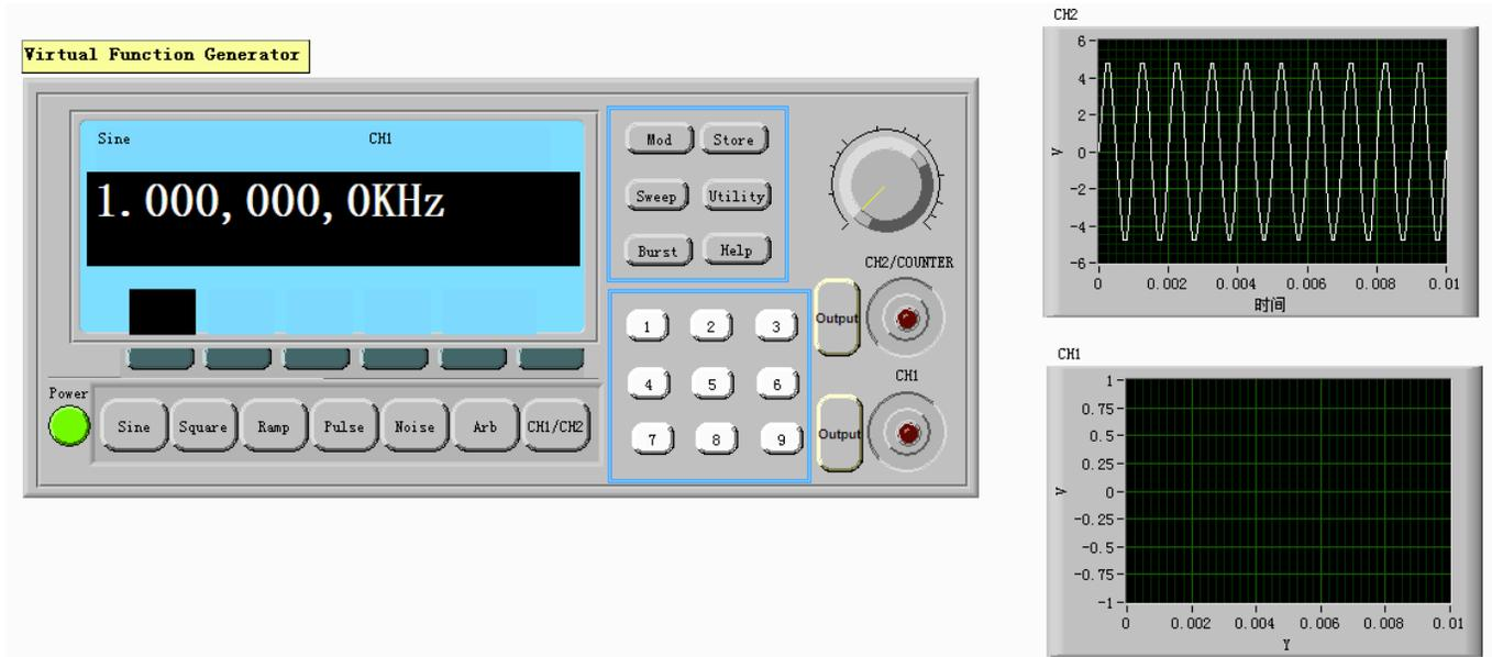
Fig. (8). Virtual function generator.
