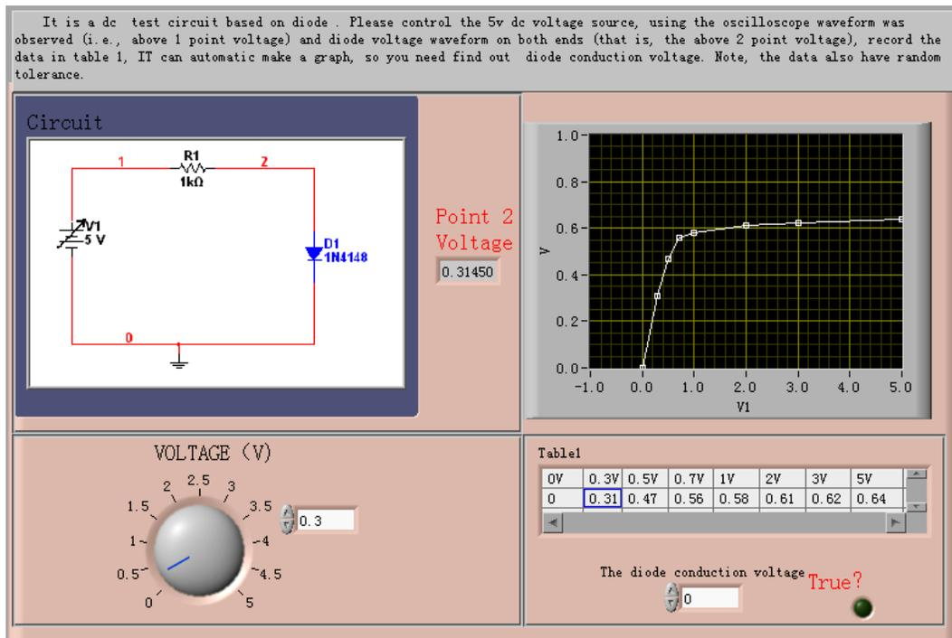
Fig. (7). Diode DC test circuit.
